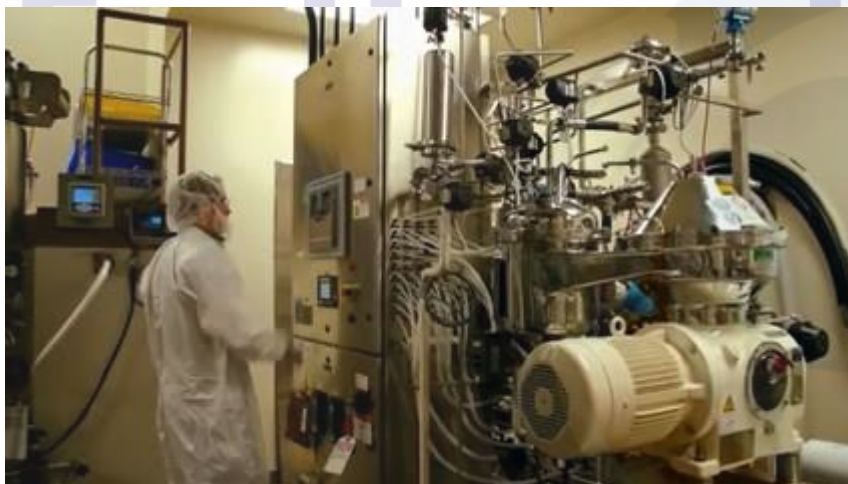
Pemisahan antigen dari sel bisa juga dilakukan dengan sentrifugasi.
